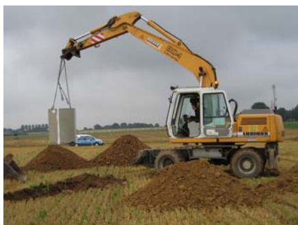
Photo 3. Installation du lysimètre dans la fosse creusée en séparant les horizons de sol
